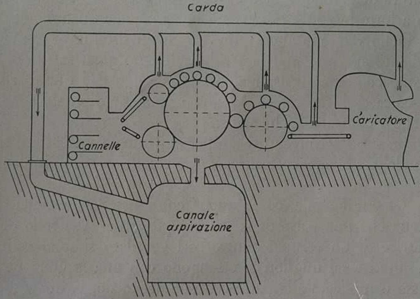
Fig. 6. Schema dell'impianto di vuoto dell'azienda dell'6
